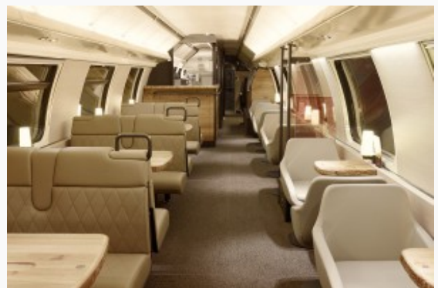
Die Beleuchtung besteht aus einem indirekten Teil und eigens gestalteten Tischleuchten an den Plätzen | Foto: Milani Design
